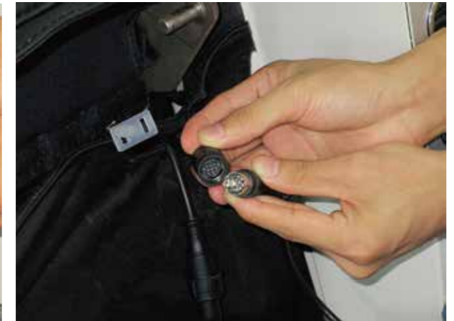
Connectors of thirteen-pin plug connect together Les connecteurs de la fiche à treize broches s'attachent ensemble
