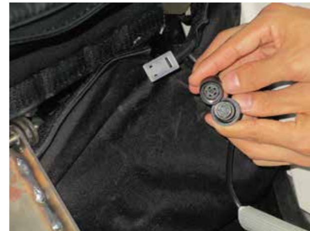
Connectors of four-pin plug connect together Les connecteurs de la fiche à quatre broches s'attachent ensemble
